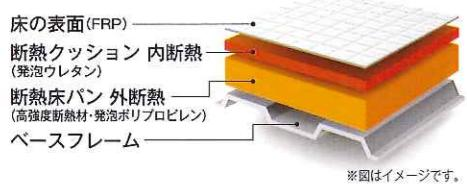
「W断熱構造」が床裏からの冷気をシャットアウト。優れた断熱性能で室温とほぼ同じ温度を実現しました。
