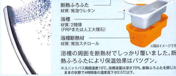
浴槽の周囲を断熱材でしっかり覆いました。断熱ふろふたにより保温効果はバツグン。
