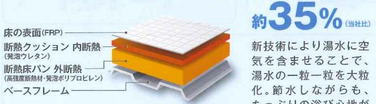
「W断熱構造」が床裏からの冷気をシャットアウト。優れた断熱性能で室温とほぼ同じ温度を実現しました。
